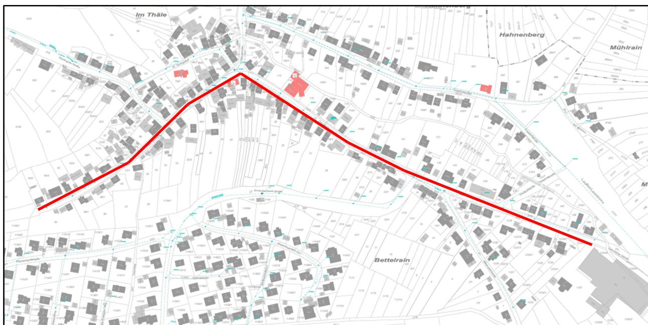
Erneuerung der Wasserversorgungsleitungen in der gesamten Ortsdurchfahrt auf einer Gesamtlänge von ca. 925 lfm zzgl. der Hausanschlussleitungen sowie der Anbindungen in den Seitenbereichen.
